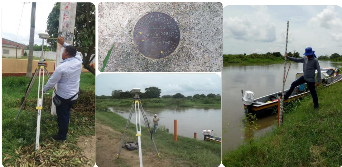
Figura 3-13 Procedimiento levantamiento del cero de mira de la estación del río Fundación. Fuente: (GUTIERREZ, 2018)
