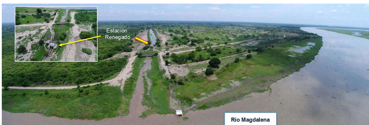
Figura 4-24. Ubicación de la estación Renegado sobre un costado del río Magdalena, se observa el canal de acceso de las aguas y como se encuentran obstruido por restos vegetales, residuos sólidos que son arrastrados hasta la bocas del sistema de compuertas de paso de estación Renegado.
