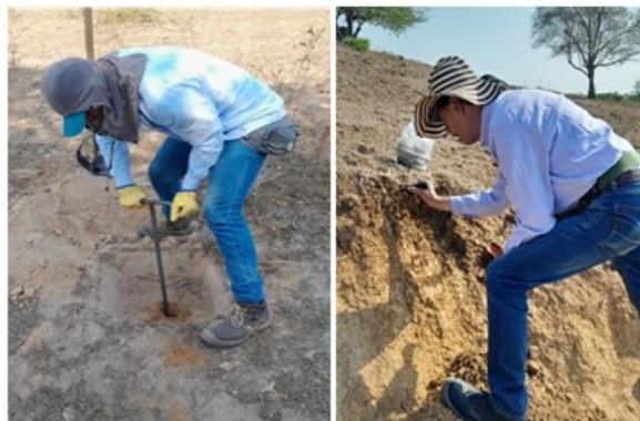
El trabajo de campo tuvo como propósito identificar y comprobar el contenido pedológico de las áreas observadas, a partir de la información edáfica secundaria, la actividad se ejecutó mediante la apertura de cajuelas y el empleo del barreno, esta labor conllevó a la selección de los puntos de muestreo finales.
