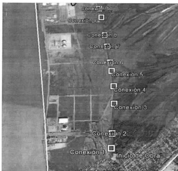
Estos puntos permitirán el tránsito de las aguas de escorrentía de un lado hacia el otro de la vía. Los que no se desarrollen rápidamente, podrán usar estas estructuras hidráulicas para la conectividad hídrica de ambos lados de la vía. Por su parte, en aquellos lotes en los que se
