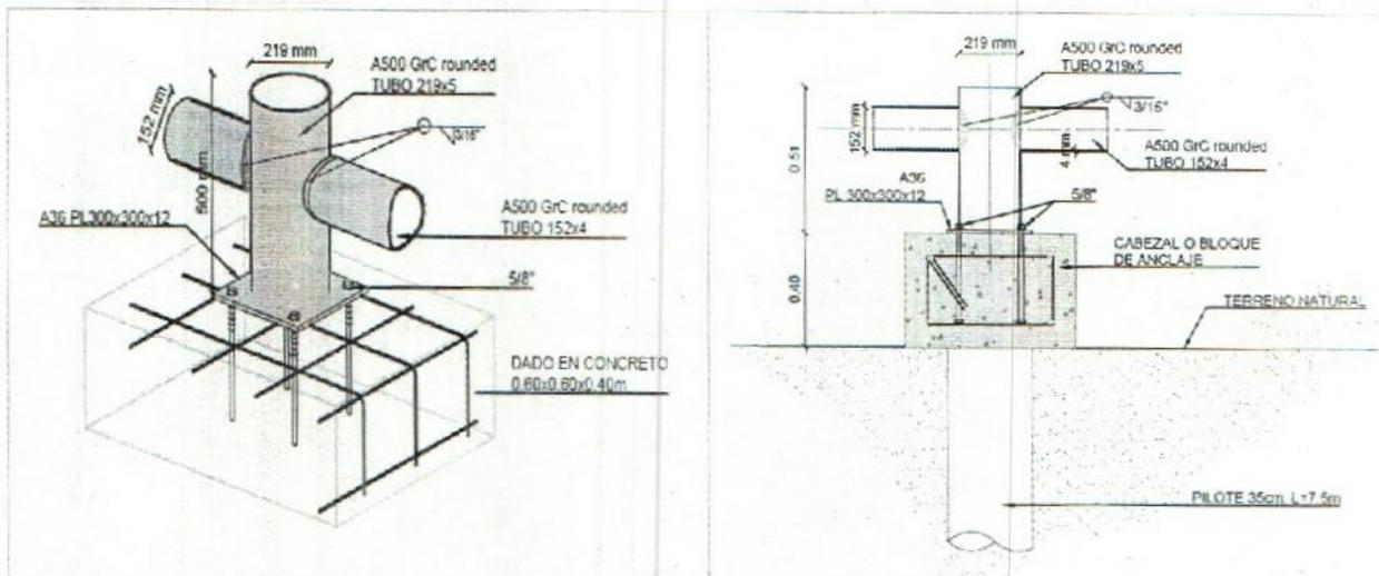
Figura 2. Macizos de anclaje a construir en los puntos de amarre del muelle flotante. Fuente: Adaptado Información técnica aportado
