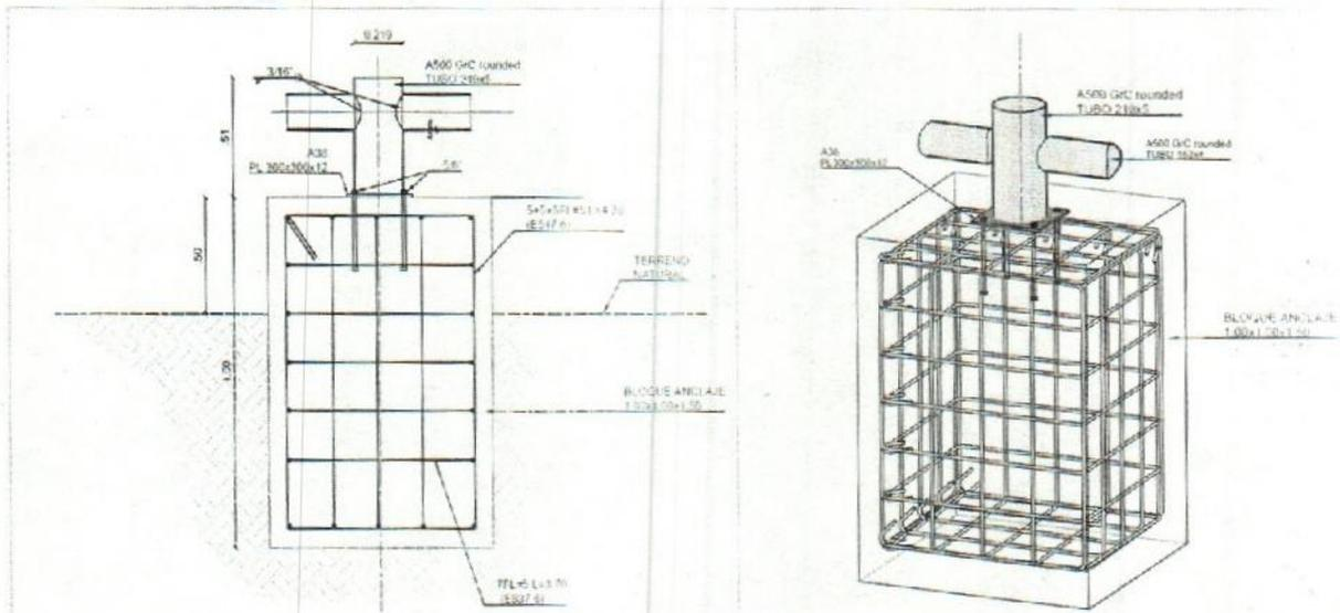
Figura 2. Macizos de anclaje a construir en los puntos de amarre del muelle flotante. Fuente: Adaptado Información técnica aportado
