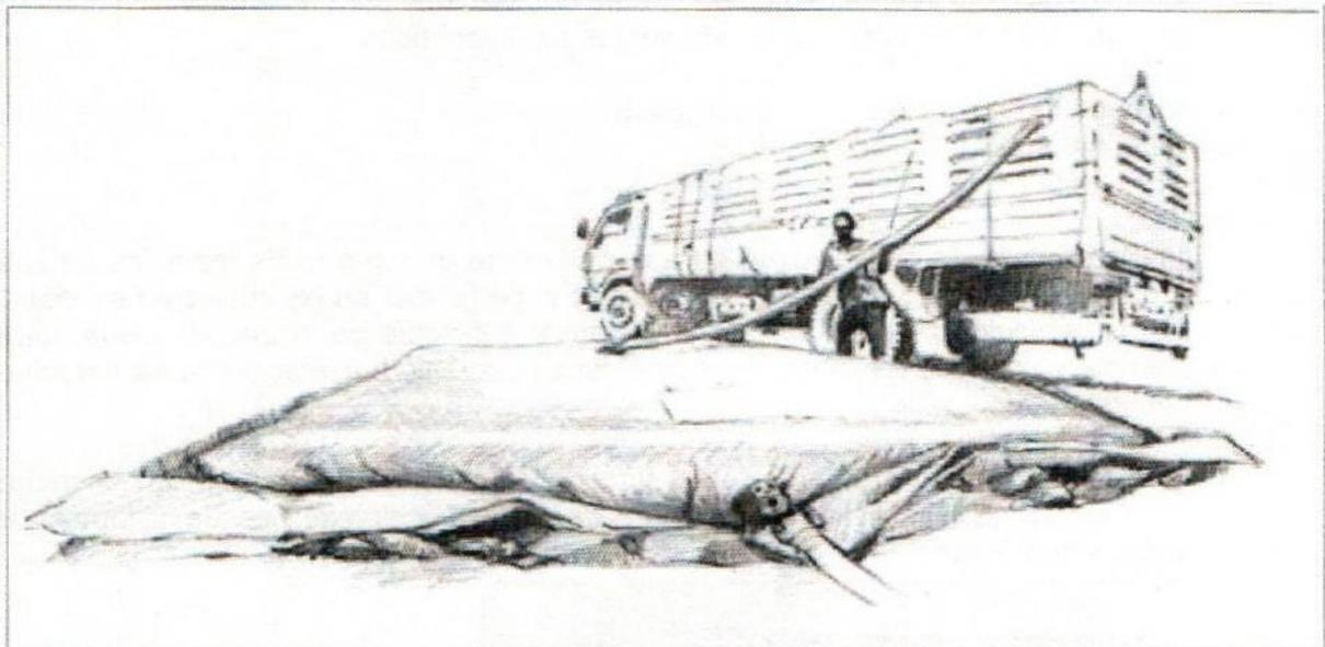
**Figura1.** Imagen de la captación basado en el bombeo directo desde el cauce del Río hasta el carrotanque, encargado del transporte del agua hasta los diferentes puntos de la obra.
