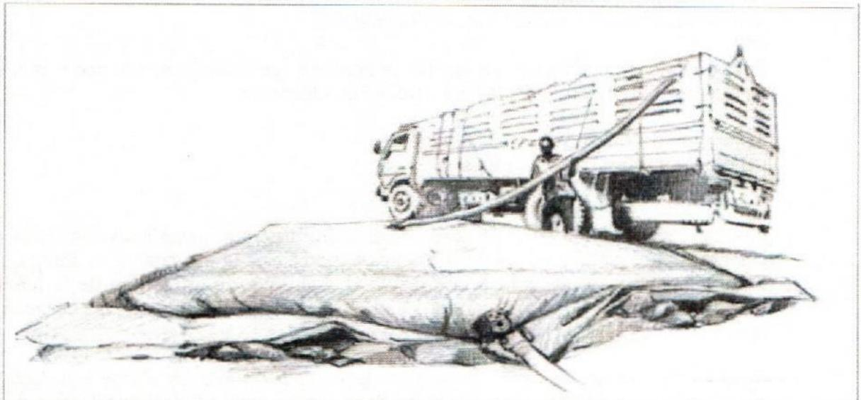
**Figura1.** Imagen de la captación basado en el bombeo directo desde el cauce del Río hasta el carrotanque, encargado del transporte del agua hasta los diferentes puntos de la obra.
