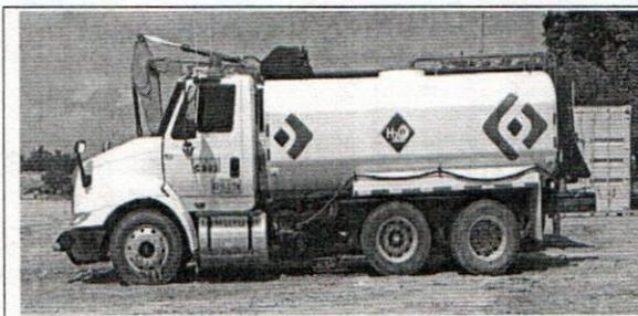
Vehículo para transporte de agua y riego de vías y áreas destapadas
