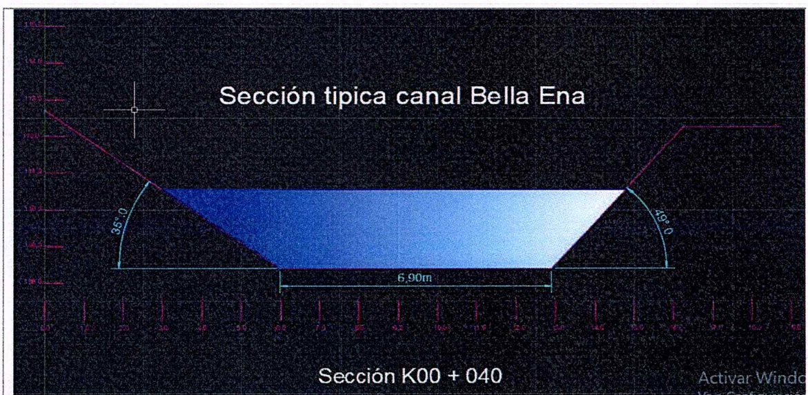
Figura2. Sección transversal canal Bella Ena
