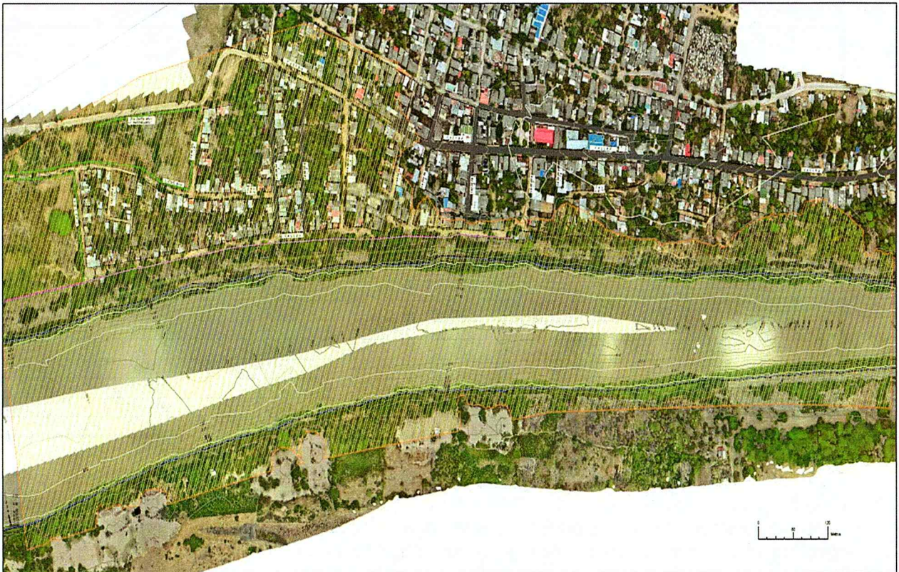
Ilustración 8 Plano de niveles máximo de inundación Tr 100 – 17.90 m.s.n.m.
