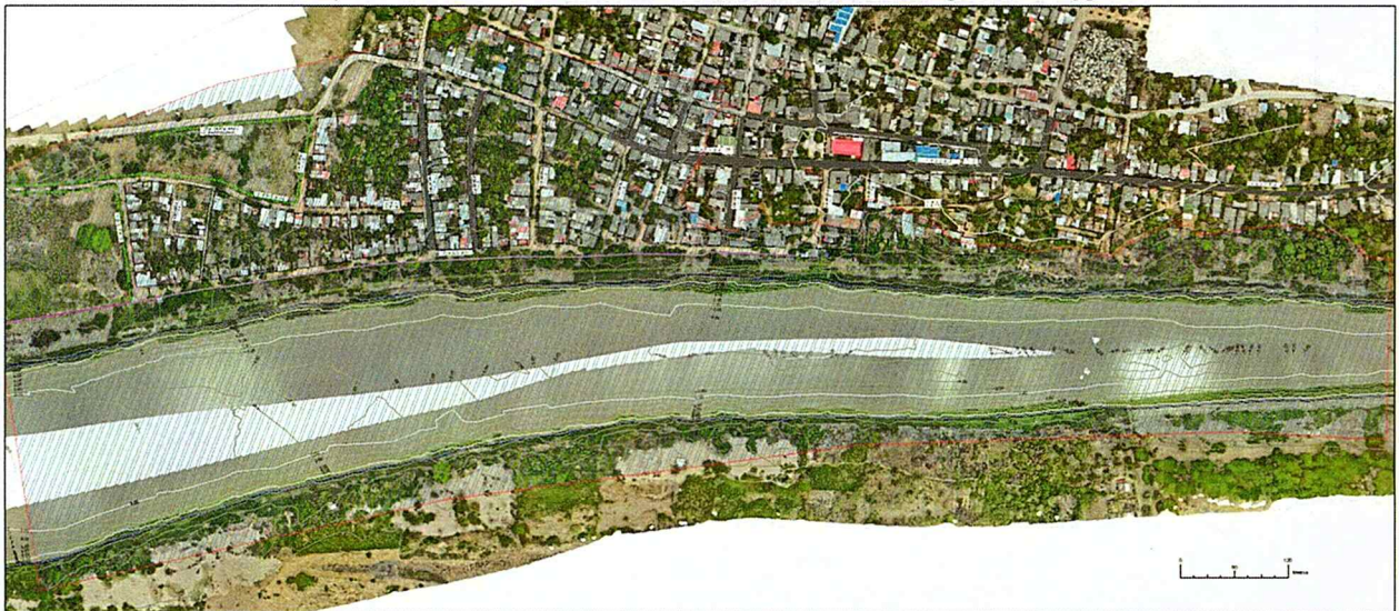
Ilustración 7 Plano de niveles máximo de inundación Tr 500 – 18.45 m.s.n.m.
